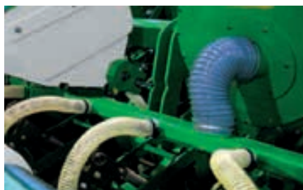
Turbina molto silenziosa ad elevata potenza e portata, può alimentare fibo a 18 elementi, con P.T.O. 540 giri/min (750 giri/min a richiesta). Nelle versioni a telaio fisso a partire da 12 file e 18 file bietola e per tutte le versioni a telaio telescopico si adotta un collettore metallico
