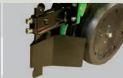
8 Vomerino spargizolle regolabile in altezza, con coltro indipendente anch'esso regolabile.
