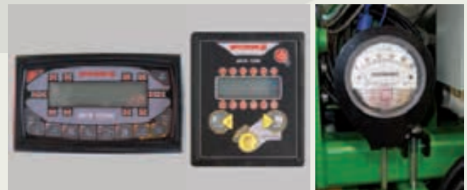
Monitor di semina (accessorio) con funzioni di monitoraggio semina, contaetari parziale e totale, contatore semi, misuratore velocità di avanzamento, controllo investimento semi e altro a seconda del modello.
