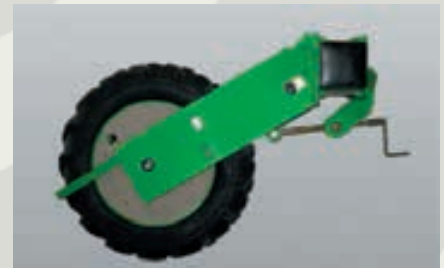
Ruota tractor regolabile in altezza con manovella (ruota normale o maggiorata).
