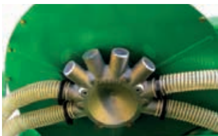
Turbina molto silenziosa ad elevata potenza e portata, può alimentare fibo a 18 elementi, con P.T.O. 540 giri/min (750 giri/min a richiesta). Nelle versioni a telaio fisso a partire da 12 file e 18 file bietola e per tutte le versioni a telaio telescopico si adotta un collettore metallico
