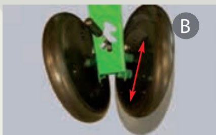
7 Le leve di regolazione per la profondità (A) e per la pressione di rinalzo (B) permettono di cambiare velocemente l'impostazione della macchina. La regolazione risulta molto rapida ed intuitiva, inoltre facilmente riproducibile su tutti gli elementi. Questi dispositivi non sono sensibili all'accumulo di polvere e sporco. Il gruppo di rinalzo è indipendente dall'elemento di semina; può oscillare per seguire meglio il profilo del terreno. È inoltre molto ravvicinato al punto di semina.
