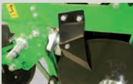
6 Raschiaterre interni ed esterni di serie per i dischi aprisolo.
