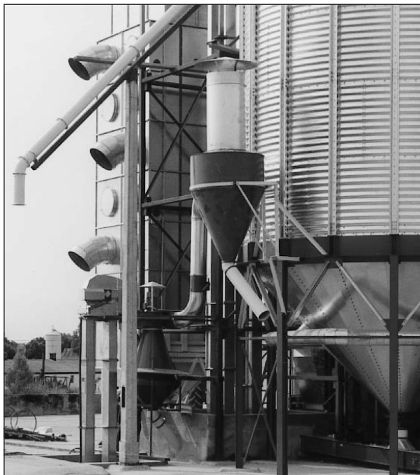
Předčistička KF 40 a sušárna v Německu
